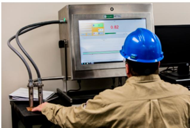
▲ 易于使用的 SpecMetrix 系统软件，可更快地获得 DFT 干膜厚度测量结果。
