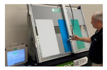
▲ 膜重测试站具有高度精确和快速的特点,在单点和扫描模式下提供高精度、非接触式厚度测试。
